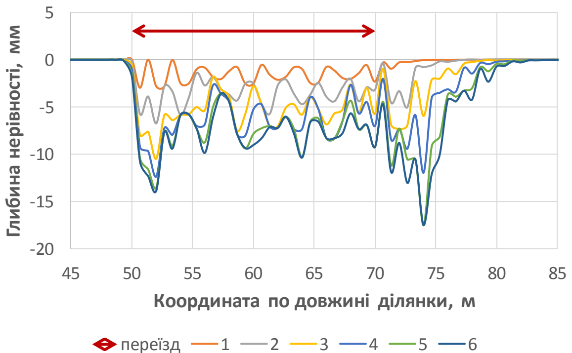
Рисунок 6.6 – Моделювання розвитку нерівності колії в зоні переїзду:
