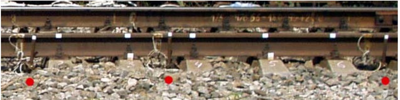
Рисунок 4.2 – Послідовність трьох перерізів рейки, обладнаних датчиками
