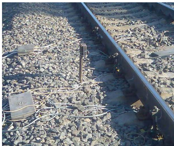
Рисунок 4.9 – Послідовність трьох перерізів рейки, обладнаних датчиками
